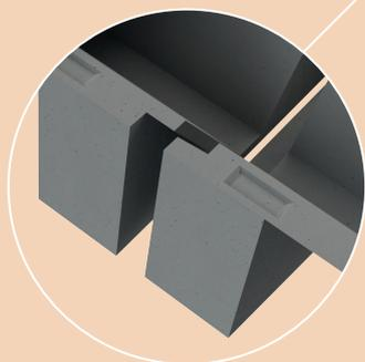
Unión machihembrada que garantiza la estanquidad.
